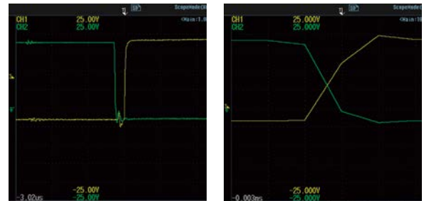
变频器门极信号波形(20kHz)
